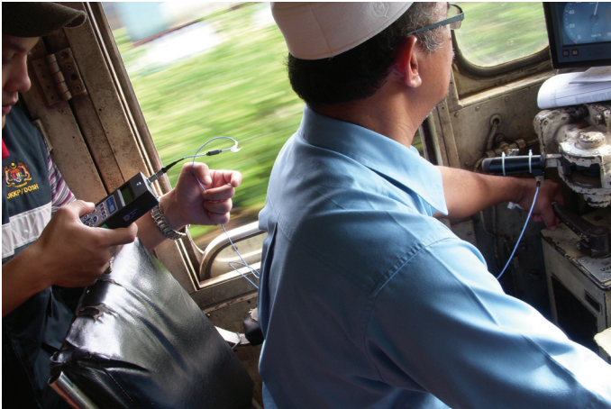
Gambar 9: Pengukuran getaran hands-arm dijalankan dengan menggunakan alat pengukur getaran. Photo 9: The hands arm vibration measurement is carried using the vibration meter.
