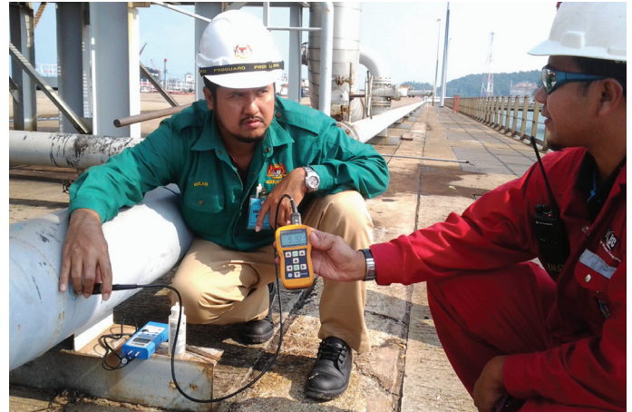
Pemeriksaan pengukuran ketebalan ultrasonik (UTM) untuk talian paip di Kemaman Port Konsertium, Kemaman. Ultrasonic thickness measurement (UTM) inspection of pipelines at the Kemaman Port Consortium, Kemaman.
