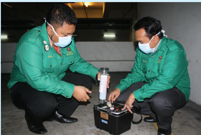
Pemasangan tabung silika ke atas alat pengesan gas radon untuk mengukur gas radon bagi menjalankan kaedah pemantauan penuh. Installing silica canister into a radon gas detector to measure radon gas level in order to carry out full monitoring method.
