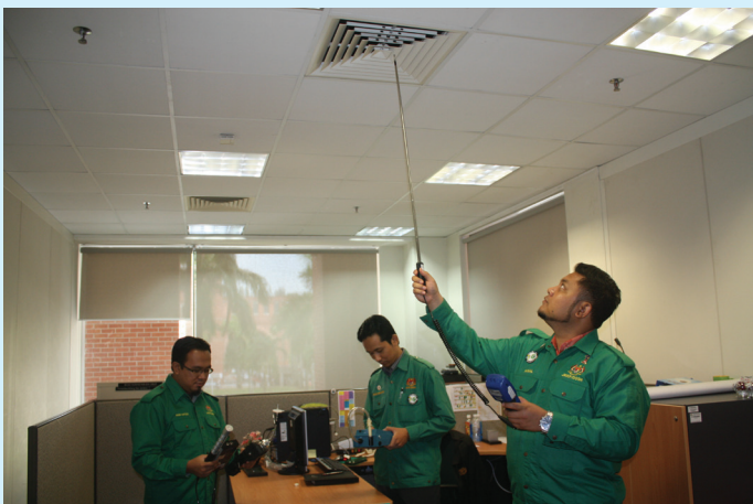
Pemantauan parameter kualiti udara dalaman ketika menyiasat masalah kualiti udara dalaman di salah sebuah jabatan kerajaan. Monitoring internal air quality parameter in an internal quality problem investigation at a Government agency office.
