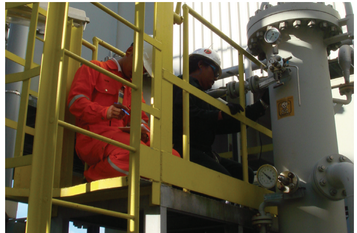
Sesi pemeriksaan dan verifikasi data pengukuran ketebalan ultrasonik (UTM) ke atas dinding jentera yang berperakuan di Malaysia LNG Sdn Bhd, Bintulu Sarawak. Inspection and verification of ultrasonic thickness measurement (UTM) data of the walls of certified machinery at Malaysia LNG Sdn Bhd in Bintulu, Sarawak.
