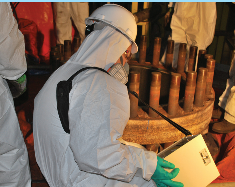
Gambar 13 dan 14: Alat penganalisis merkuri digunakan semasa pemantauan merkuri dijalankan. Photos 13 & 14: The mercury analyser is used to monitor mercury.
