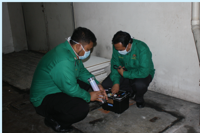
Pengukuran gas radon menggunakan pengesan gas radon di ruang bawah tanah. Measuring radon gas level using a radon gas detector in an underground area.
