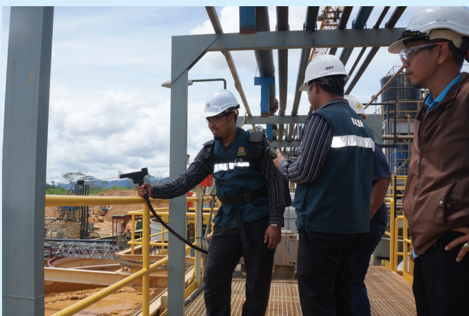
Pemantauan hidrogen sianida menggunakan spektroskopi inframerah transform fourier (FTIR) di lombong emas. Hydrogen cyanide monitoring using a fourier transform infrared spectroscopy (FTIR) in a gold mine.
