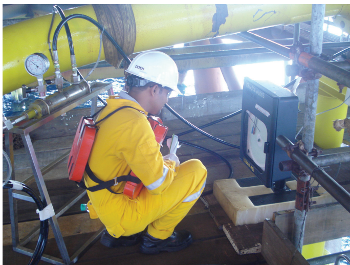
Menyaksikan ujian hidrostatik pada talian paip penaik di atas pelantar minyak dan gas Angsi milik Petronas Carigali Sdn Bhd di luar perairan Terengganu. Observing hydrostatic testing on the riser pipeline at Angsi oil and gas platforms owned by Petronas Carigali Sdn Bhd off the coast of Terengganu.
