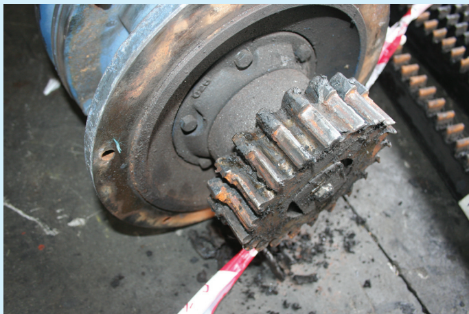
Gambar 7: Kegagalan lesu yang dikesan pada mekanisma pinan pada sebuah lif orang di Selangor. Photo 7: Failure caused by metal fatigue detected at the pinion mechanism of a manlift in Selangor.
