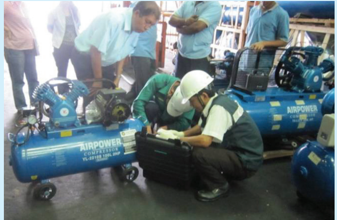
Gambar 12: Pemeriksaan UTG ke atas pengandung tekanan tak berapi di salah sebuah syarikat pembekal. Photo 12: UTG inspection on an unfired pressure vessel at a supplying companies.
