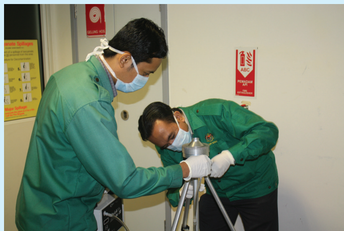
Pengambilan sampel media bagi bahan cemar biologik untuk parameter kualiti udara dalaman. Collecting media sample of biological pollutants for internal air quality parameter.
