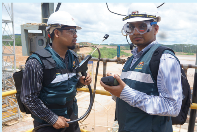
Pemantauan hidrogen sianida menggunakan spektroskopi inframerah transform fourier (FTIR) di lombong emas. Hydrogen cyanide monitoring using a fourier transform infrared spectroscopy (FTIR) in a gold mine.
