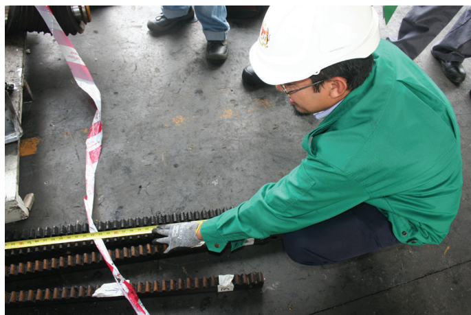
Gambar 1: Pegawai BKF sedang meneliti komponen gear yang terlibat dalam kes kemalangan di Selangor.
