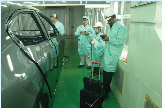
Mengukur dan mengenal pasti pendedahan bahan kimia di sebuah kilang automatik di Melaka menggunakan spektroskopi inframerah transform fourier (FTIR). Identifying and measuring chemical exposures at an automotive plant, in Melaka, using a fourier transform infrared spectroscopy (FTIR).
